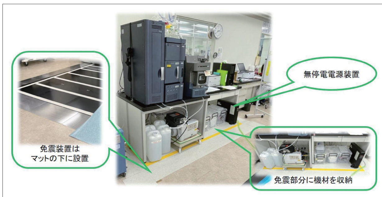
図2 大型測定機器に設置した免震装置
